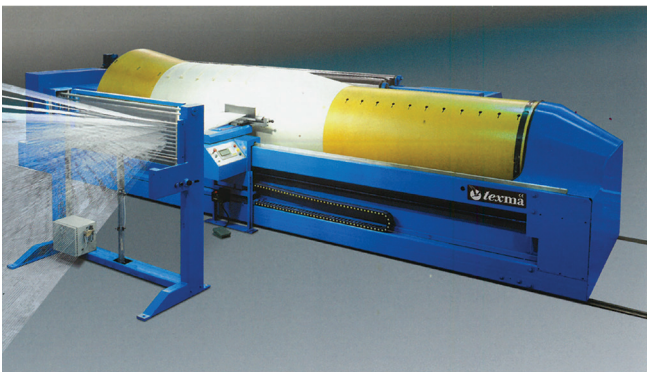
Visita cabezal de enrollado y parafinador en urdidores OR-25 CP View of the warping head winder and paraffin device OR-25 CP
